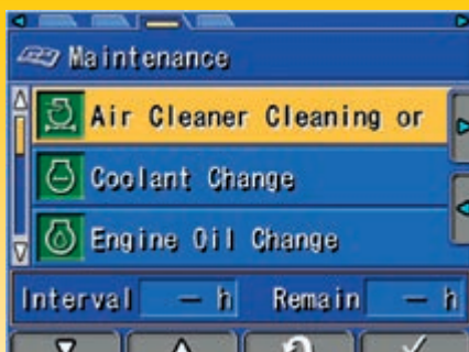
L'écran multifonctions indique à l'opérateur les informations relatives à l'entretien de la machine
