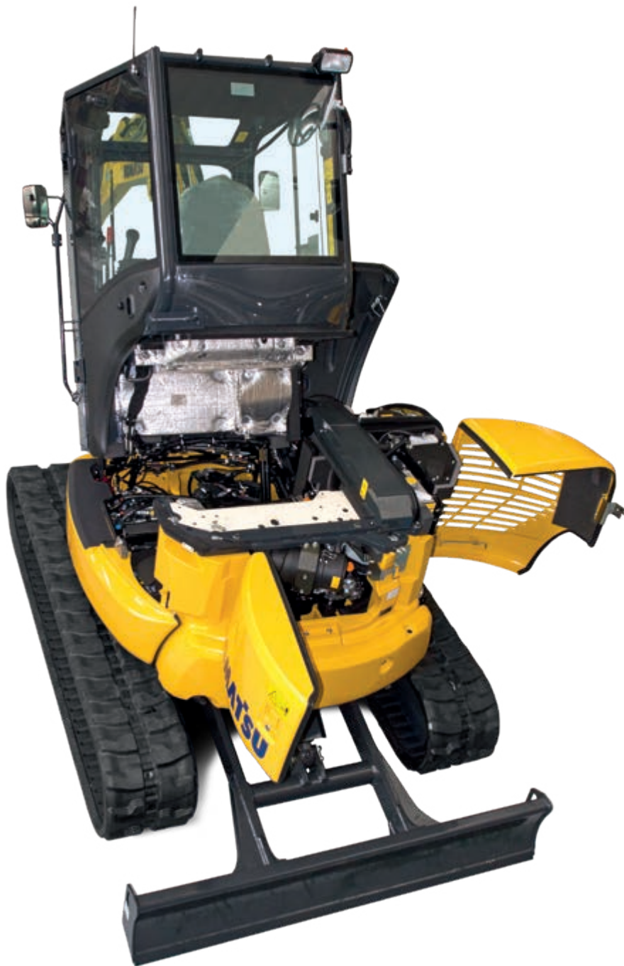
Capots arrière pour contrôle rapide des éléments du moteur, simple inspection et nettoyage des radiateurs et accès facilité à la batterie
