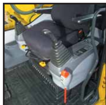
Plage de glissement du siège: 340 mm
