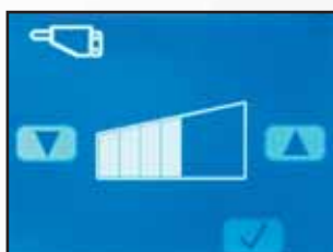
Ecran réglage fin du débit hydraulique en mode B (marteau).
