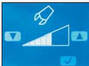
Ecran réglage fin du débit hydraulique en mode P (puissance) ou E (économique).
